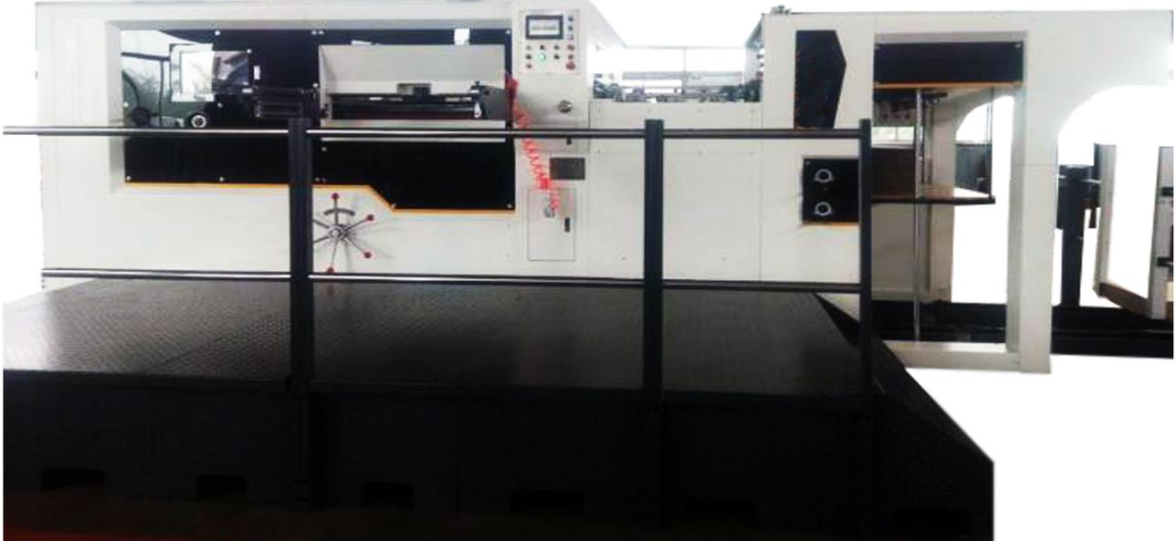
Alimentador automático por succión / Stripping / dispositivo anti obstáculos / detección.doble hoja /
