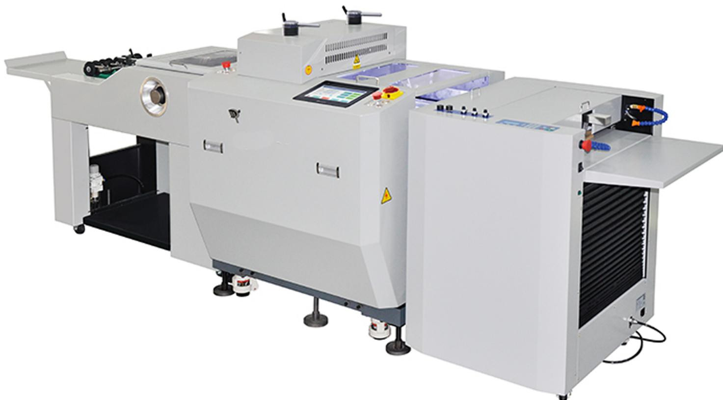
Pantalla táctil intuitiva / Sensor de ultrasonidos para detección de doble hoja / Control de movimiento de pinzas por servomotor / admite placas de troquelado flexibles de 0,6 a 0,8 mm. de grosor.
