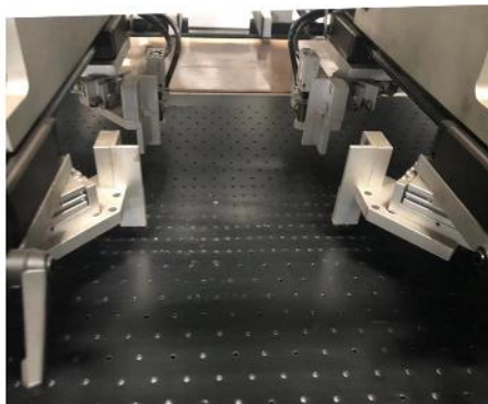
Pieza formadora de caja automática. Dispositivo de sujeción de caja automático anti-fricción (elevación de 15 mm)
