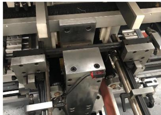
Dispositivo de alarma de bloqueo automático en descarga y alimentación
