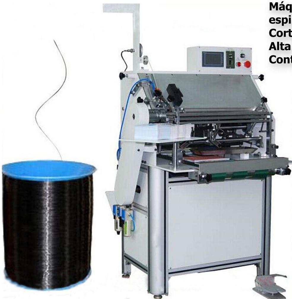
**Máquina para formar e insertar espiral metálica.
