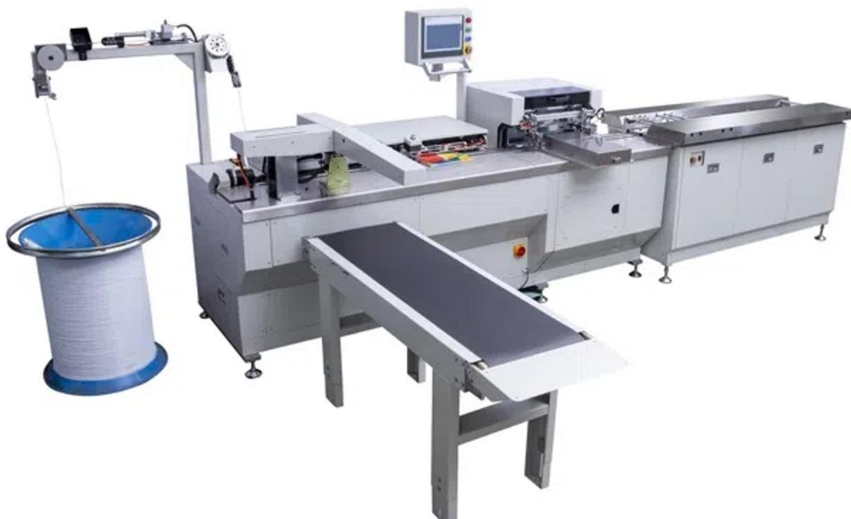
**Alimentación automática, perforado de papel / tapa, formación de espiral y encuadernado completo en una sola máquina.**
