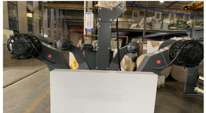
**Bastidor de descarga sin eje hidráulico de doble brazo**
