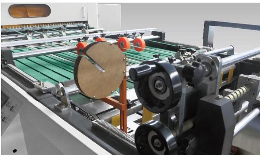
**Equipado con dispositivo de inserción de etiquetas y función ajustable de recepción de vibraciones de papel.**
