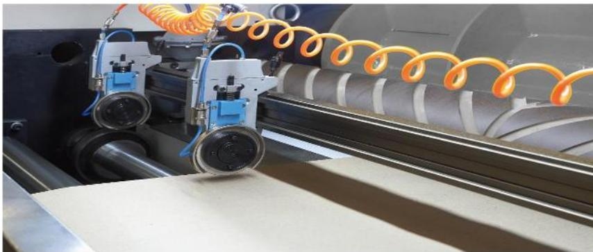
**Juego de cuchillas de corte neumáticas diseñadas en una sola pieza con riel deslizante de cola de milano.**
