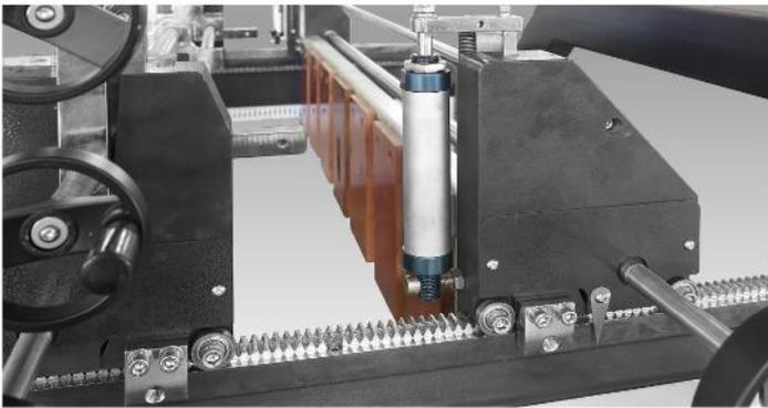
**Equipado con función de elevación automática del deflector de entrega**
