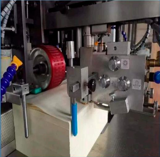
1. Sistema de control de altura de pila sensible. En el alimentador de papel, la pila siempre se mantiene a una altura adecuada para que la alimentación sea suave.
