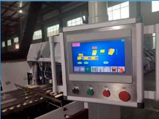
4. Pantalla de visualización: pantalla táctil giratoria en color para realizar el diálogo hombre-máquina y controlar todas las funciones de la máquina.
