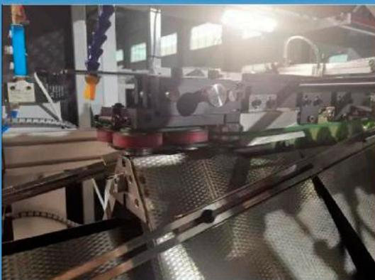
5. Mecanismo de plegado y ajuste: el plegado de una sola hoja es preciso y centrado. La presión de plegado se puede ajustar de acuerdo con diferentes tipos de papeles.
