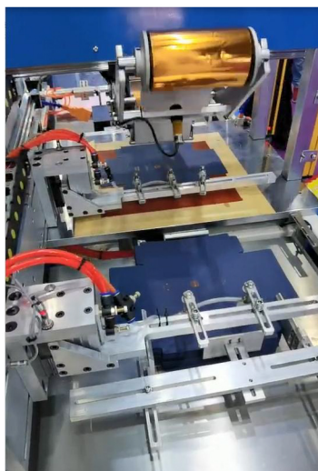
Alimentador con control de motor paso a paso.
