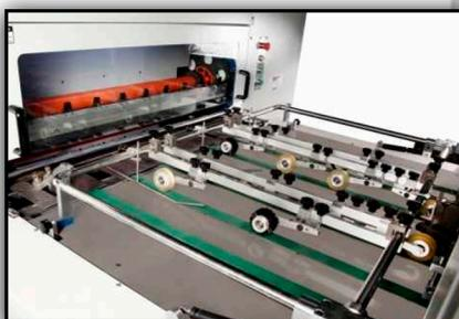
**Cabezal de alimentación para cartulina, cartón y cartón ondulado. Cuenta con cuatro puntos de succión y cuatro puntos de alimentación. El ángulo de succión se puede ajustar según la deformación del papel.**
