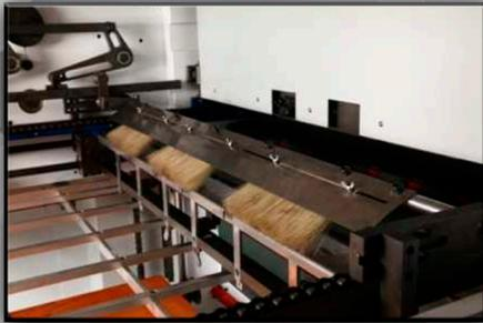
El dispositivo automático de nivelación de papel y el soplador de aire bidireccional para la salida del papel aseguran una entrega uniforme de papel.
