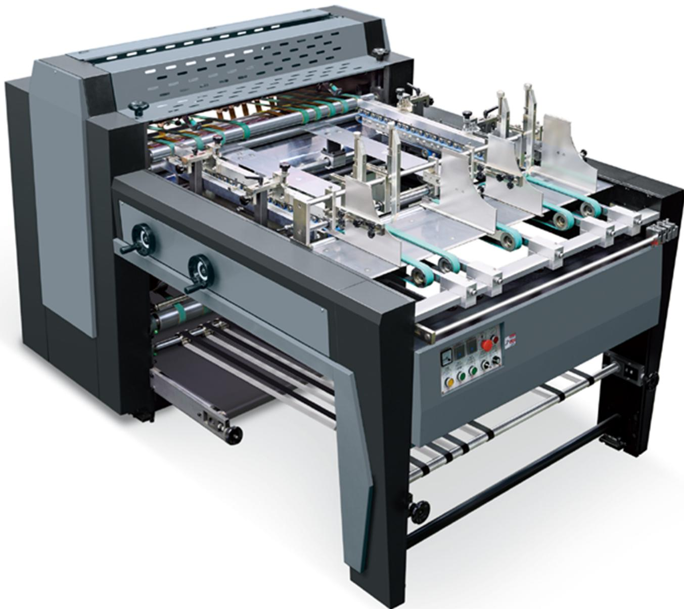
La máquina está especialmente diseñada para hacer fresados tipo V y U, muy indicada para la industria del cartón gris compacto , cajas rígidas de cartón y otros cartones varios. Es adecuada para realizar diferentes tipos de cajas, y tiene una gran precisión con un bajo nivel de ruido.
