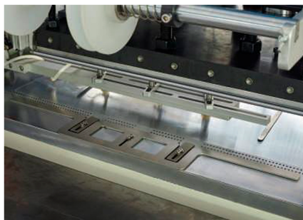
Sistema servomotor con precisión de 0,10 mm.
