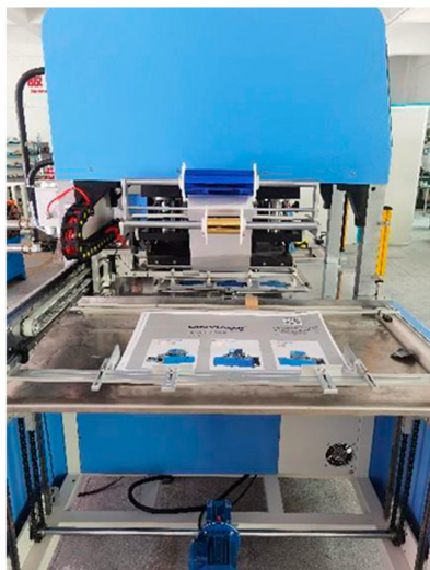
Control de alimentación depapel con servomotor. Dos rollos de película. Dos posiciones de película o dos colores al mismo tiempo.
