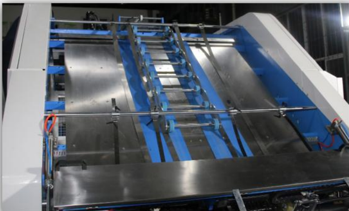
Sistema de posicionado y encolado
